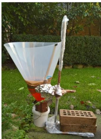
Abbildung 3.2: Aufbau der Wasserauffangstation
