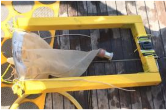
Abb. 3.1: Manta-Trawl zur Gewinnung von Schwebstoffen wie z.B. Mikroplastikteilchen mit einer Größe > 200 µm
